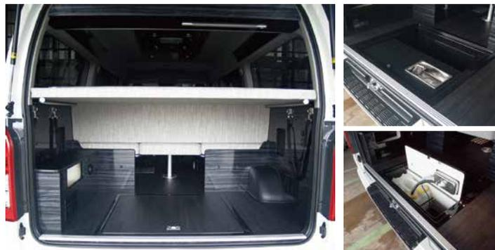
後部フロアにFRPボックスを設置し室内高さ1600mm以上を確保して8ナンバー登録。
